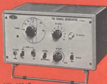
UK 460/S Generatore di segnali FM 80 ÷ 109 MHz
