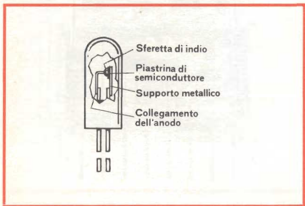
Fig. 7 - Diodo a giunzione (struttura interna).
