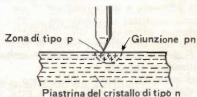
Fig. 8 - Formazione di una giunzione p-n in un diodo a punta di contatto (a forte ingrandimento).
